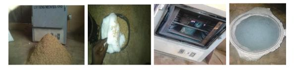
(a) (b) (c) (d) **Plate 2:** (a) Rice Husk (b) Rice husk lagged with cotton wool (c) Furnace for Carbonating the rice husk (d) 150 µm Rice Husk Ash
